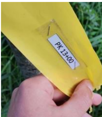
Foto 1. Mõõtepunkti (piketi) tähistuslint koos veekindla mõõtepunkti (piketi) tähisega.
